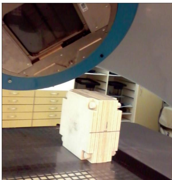
Figura 2. Setup de posicionamento do fantoma.
