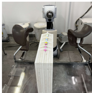
Figura 6. Arranjo experimental para perfil de dose em profundidade.
