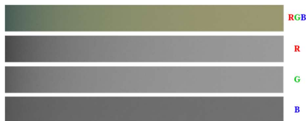
Figura 14. Filme utilizado para a obtenção das informações de intensidade de cor para perfil de dose em profundidade. A primeira fita de filme de cima para baixo mostra o filme com as três componentes de cor juntas, as restantes mostram os canais R, G e B separados e apresentados em escala de cinza.
